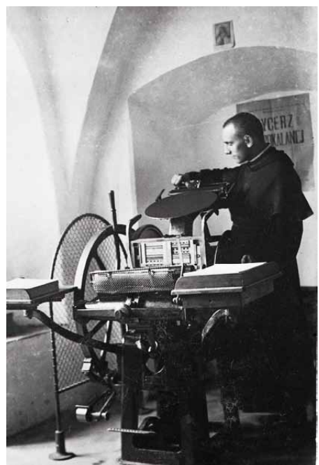
Grodno, práce na ručním tiskařském lisu; vpravo podobný dobový stroj (Chandler & Price Comp.)
